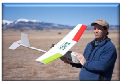
USGS RQ-11(A) Raven UAS
